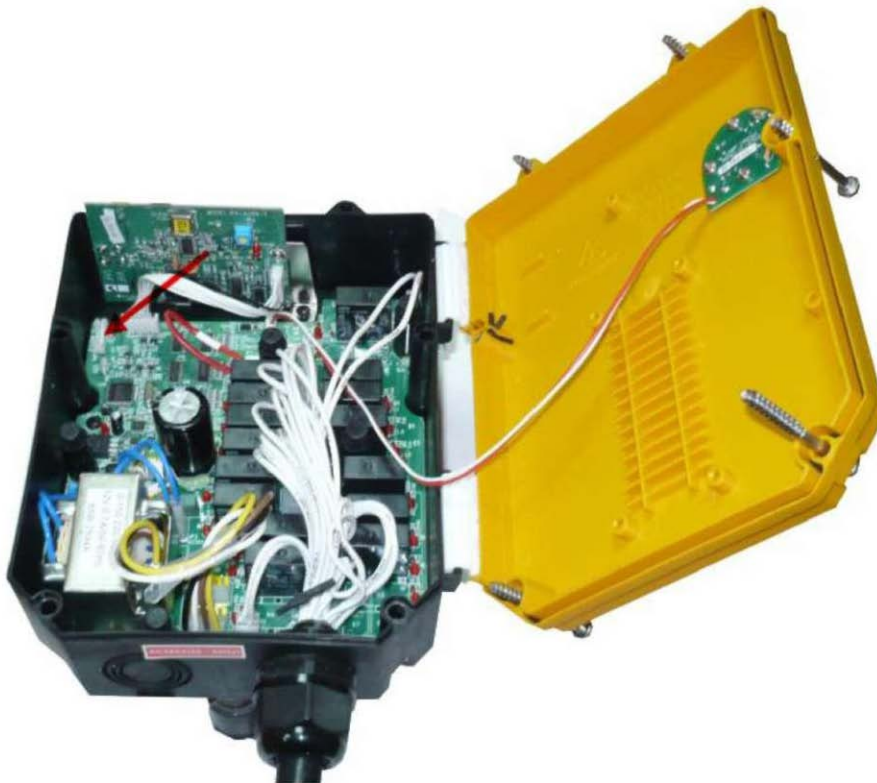
Подключение кабеля к блоку радиуправления
