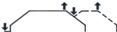
Рисунок 4. 2х тактный режим работы горелки
