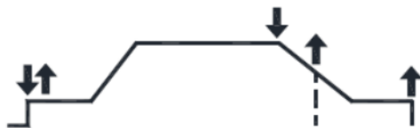
Рисунок 5. 4х тактный режим работы горелки
